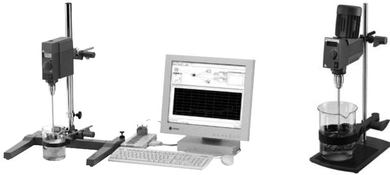
La large gamme d'agitateurs et d'outils agitateurs permet à l'utilisateur une adaptation optimale à son application - Il est également possible de piloter les agitateurs via un PC - © IKA
